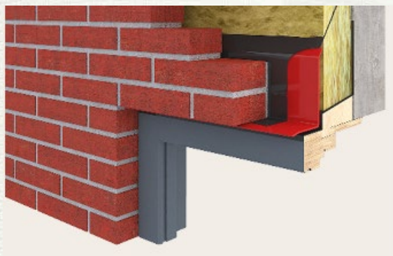
Figuur 1 Enkelvoudige stalen lateien zetting A
